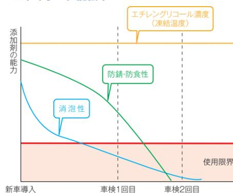
冷却水の性能は一般的に①凍結防止性能②防錆・防食性能③消泡性能とに分けられます。グラフのように②防錆・防食性能と③消泡性能は徐々に低下していきますが、①凍結防止性能は漏れ等による水の補充がなければほとんど変化しません。
